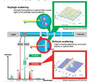
光ファイバ上の温度・ひずみについて、レイリー及び ブリルアン後方散乱光を用いて解析することができる。
