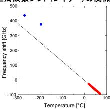
レイリー計測の結果を温度に対してプロットした。破線はラボでの計測結果。極低温では、感度が変化している可能性が高い。
