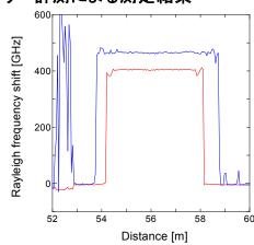
液体窒素(赤線)、液体He(青線)に浸漬させた時の 測定結果。横軸は測定器からの距離、縦軸はレイリー 後方散乱光の周波数シフト量。5cm間隔で計測した。
