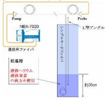
シングルモード光ファイバ素線(UV/SMF)を用いて、 テンションをかけずに冷媒(液体窒素又は液体He)に 浸漬させ、その時の後方散乱光を測定した。
