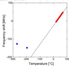
ブリルアン計測の結果を温度に対してプロットした。破線はラボでの計測結果。極低温では、温度と周波数の関係は1対1対応ではなかった。先行研究と同様の結果を得た。
